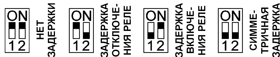
Рис. 5. Внутренние переключатели датчика.
