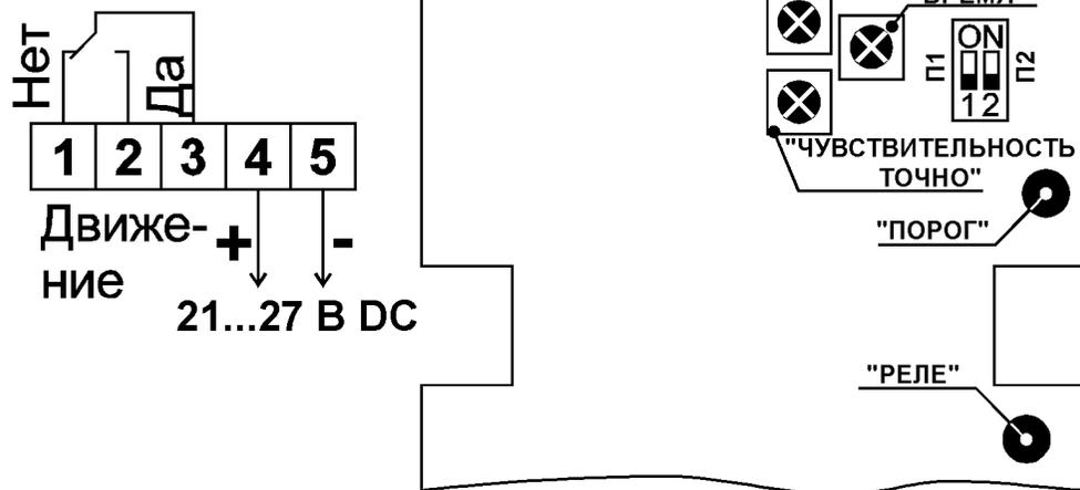
Рис. 11. Схема подключения и органы настройки датчика.
