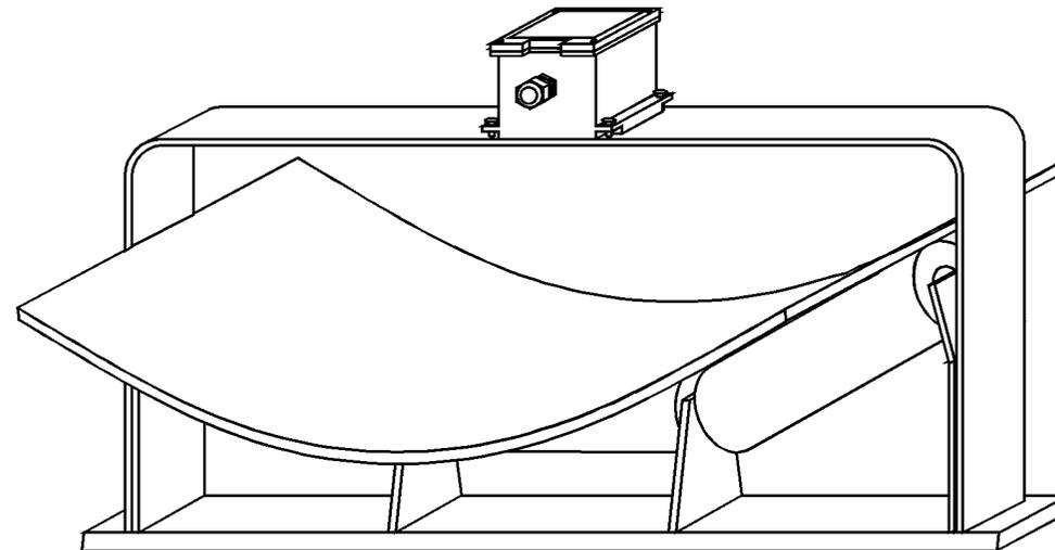
Рис. 10. Контроль наличия продукта на движущейся ленте конвейера.
