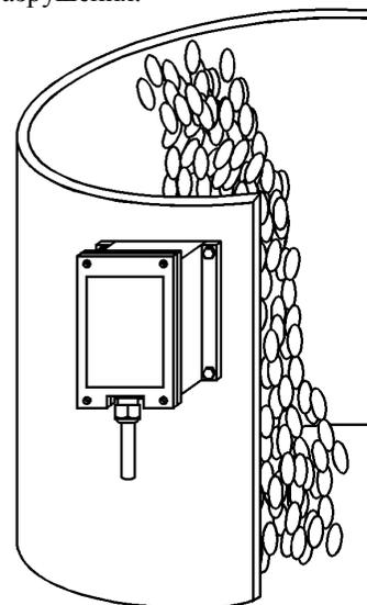
Рис. 6. Контроль движения потока продукта.
