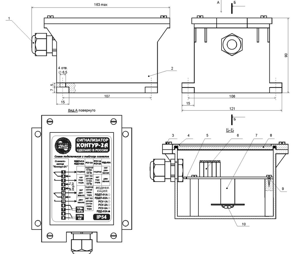
Рис. 1. Конструкция сигнализатора «Контур-2А» (модификация «РДД-02А»). На отдельной печатной плате 7 установлен приёмно-передающий модуль 10. Подключение проводов к клеммникам осуществляется через гермоввод 1.
